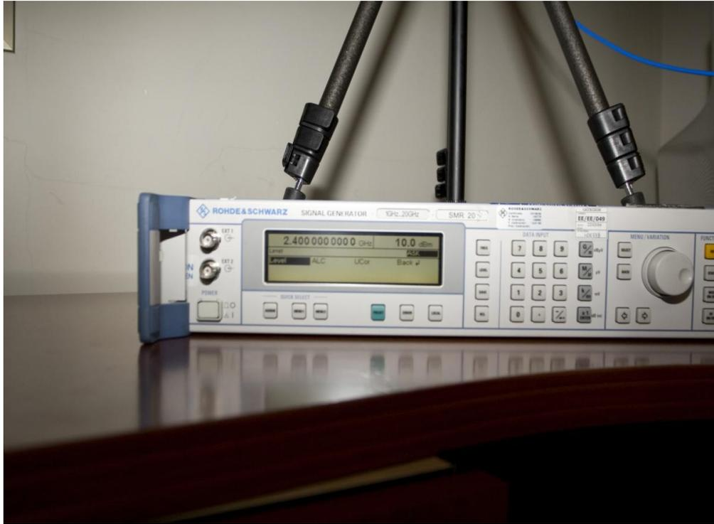
**Figura 4.4.** Generador de señal utilizado como transmisor
