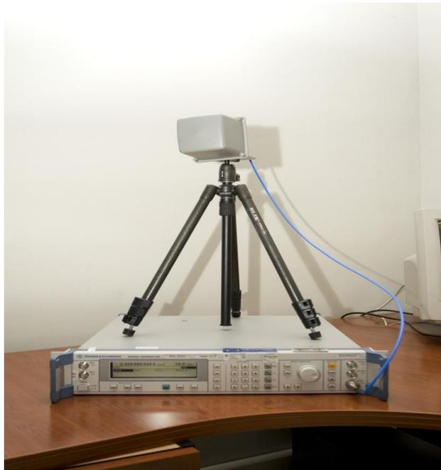
**Figura 4.5.** Conjunto transmisor, generador de señal y antena
